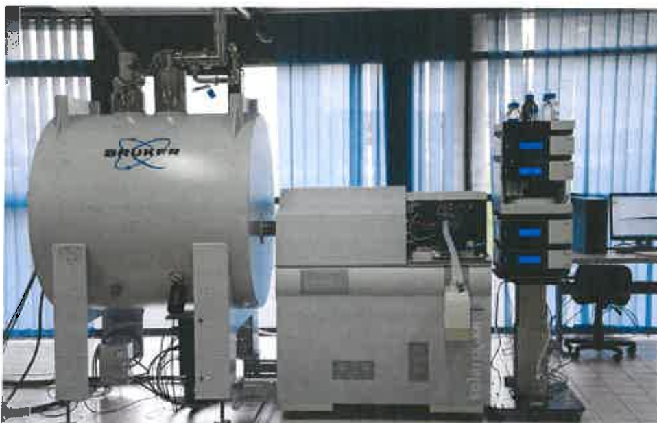
SPECTROMETRE DE MASSE FTICR POUR L'IDENTIFICATION MOLECULAIRE
